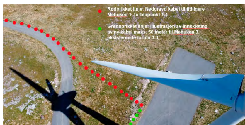
Figur 5: Eksisterende og ny 22 kV kable ved turbinpunkt 3.3. Kilde: Konesjonssøknaden.
