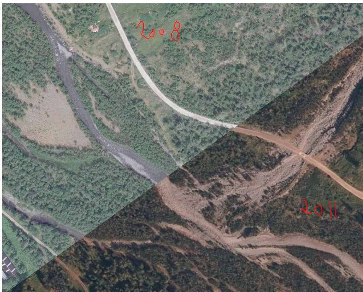
Figur 8: Sammensetning av to flybilder som viser Guolášjohka ved Oterholmen ca. 3 km oppstrøms utløpet av kraftverket. Fotoet til venstre er med vann (tatt 12.07.2008), og til høyre er uten vann (tatt 19.09.2011). Figuren er fra hydrologirapporten til Sweco (NVE 201503569-11).
