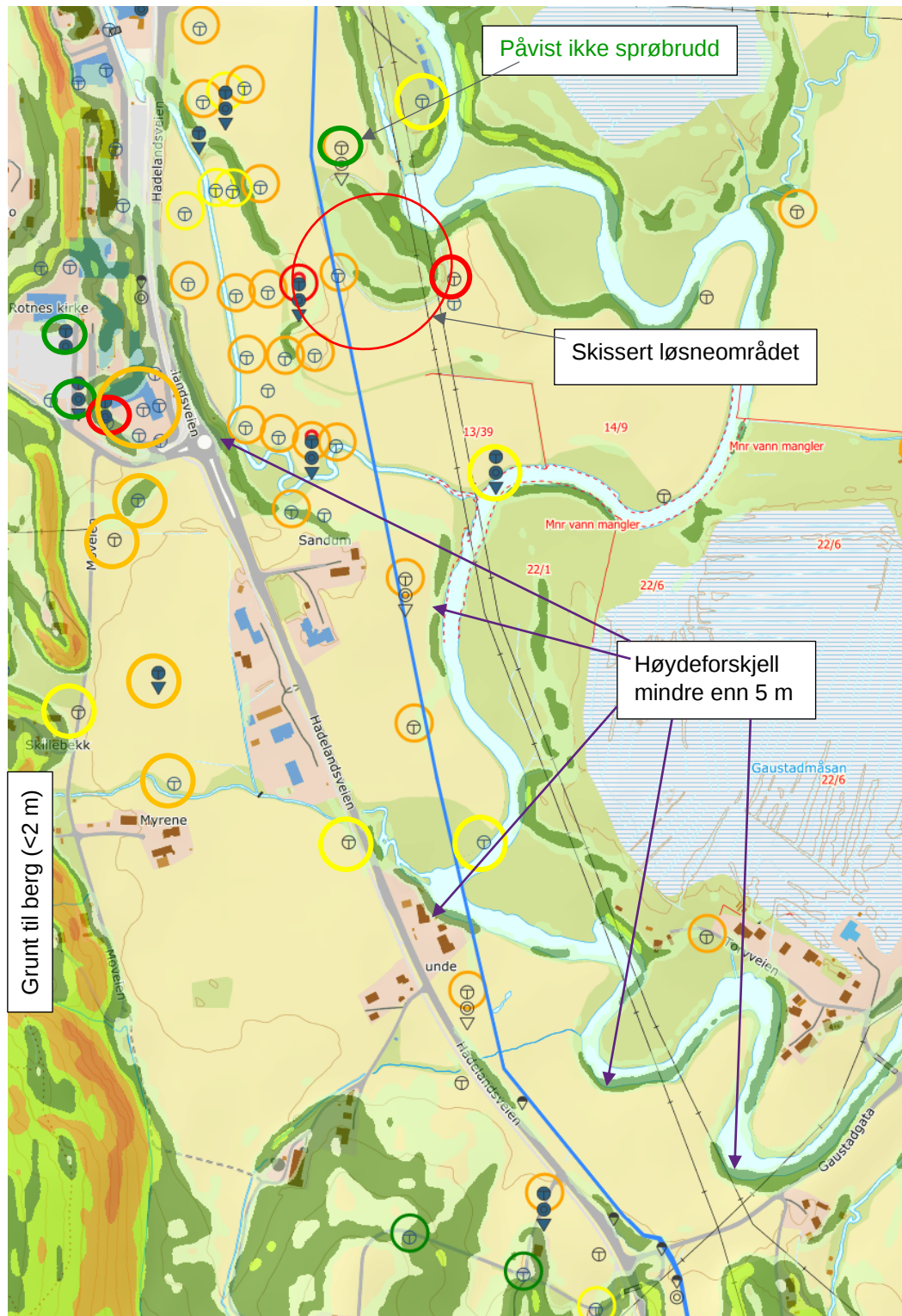
Figur 21 Oversiktsbilde med terrenghelning, borpunkt med tolket kvikkleire og skissert va-trase. Gul sirkel indikerer leire, oransje sirkel er antatt sprøbrudd og rød er påvist sprøbrudd. Grønn er enten påvist ikke sprøbrudd eller tolket å ikke inneholde leire.
