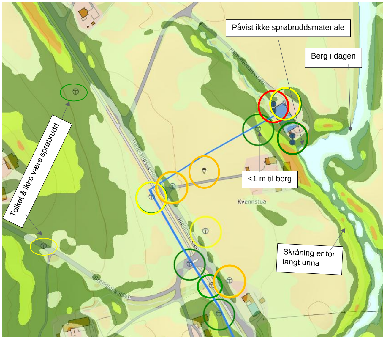
Figur 6 Oversiktsbilde med terrenghelning, borpunkt med tolket kvikkleire og skissert va-trase. Gul sirkel indikerer leire, oransje sirkel er antatt sprøbrudd og rød er påvist sprøbrudd. Grønn er enten påvist ikke sprøbrudd eller tolket å ikke inneholde leire.
