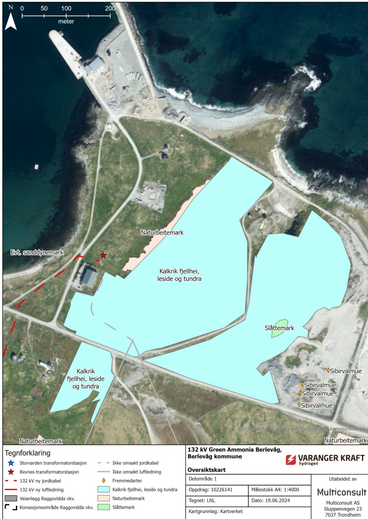
Figur 12. Forvaltningsrelevante naturtyper ved Revnes – Delområde 1 (områder som blir berørt er prioritert i kartet, dvs. naturtypen kan dekke større areal enn avtegnet). Natur blir berørt når kabler graves ned ved alternativ 1 og 2 (rød stipling, her samme trasé) og når stolper og jordkabel det siste strekket inn mot transformatorstasjon og fabrikk vil gjøre store inngrep i kalkrik fjellhei, leside og tundra og naturbeitemark. Anleggsvirksomhet kan berøre fremmede arter som ikke skal spres.
