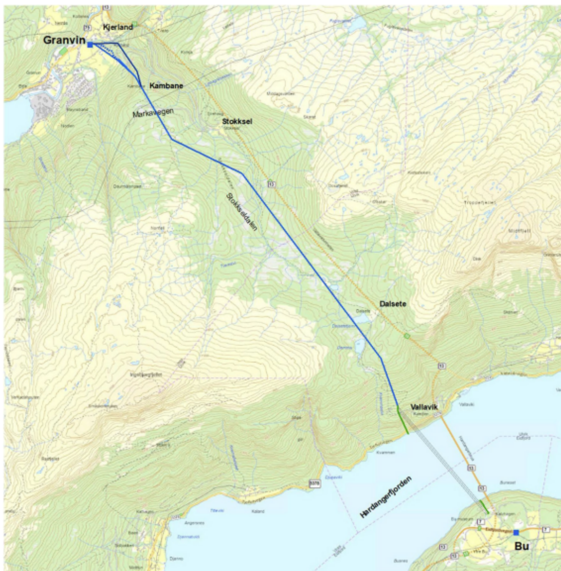
Figur 1: Blå strek viser omsøkte traseer for ny 132 kV ledning. De separate linene som er omsøkt fra spennbukkene og ned i fjorden er vist med grønn strek.
