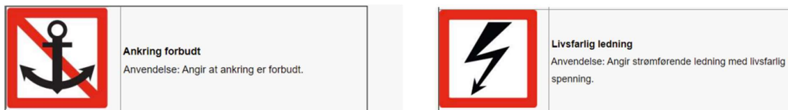
Figur 6 - Farvannsskilt kombinasjon for sjøkabel
