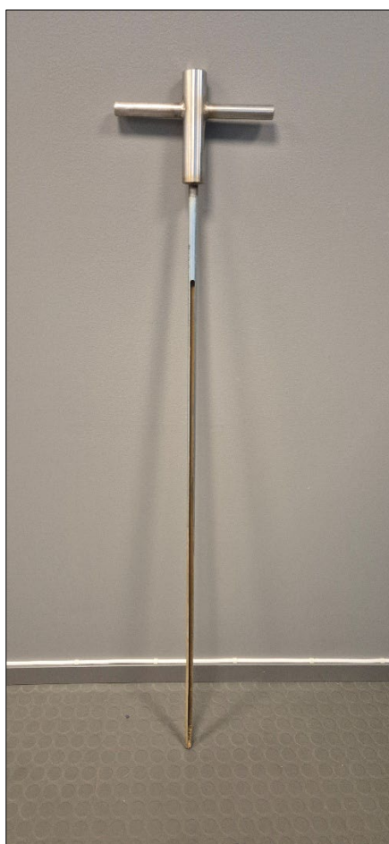
Figur 12: Boniteringsstangen som ble brukt under feltarbeidet. Total høyde er 130 cm. Stangen er hul for å kunne undersøke hvilke løsmasser det boniteres gjennom. Foto: SGC.
