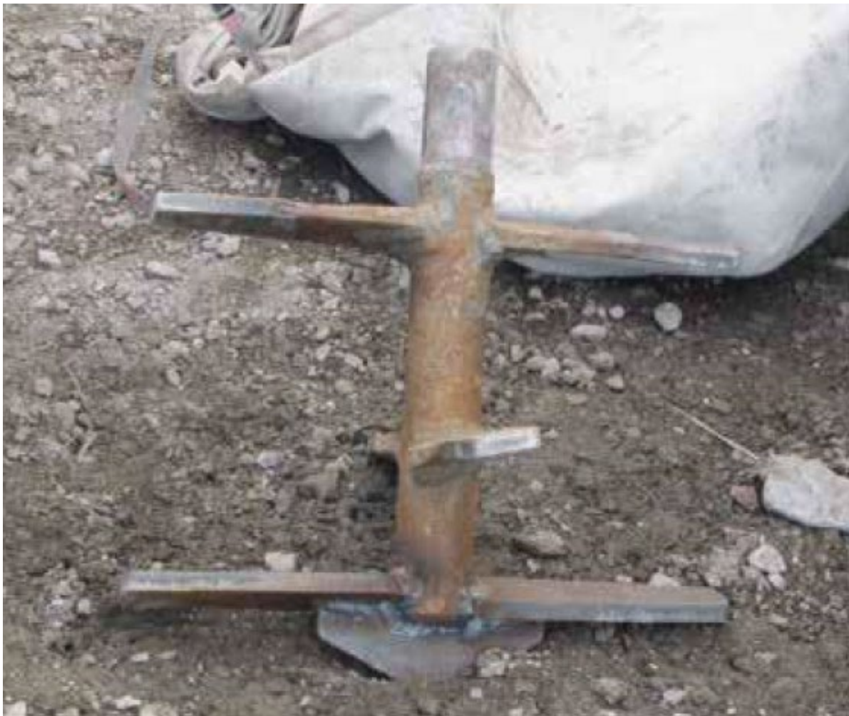
Figur 3: Eksempel på KC-‘VISP’. Kjelde: V221. Vispen har ein diameter på opptil ca. 1 m.
