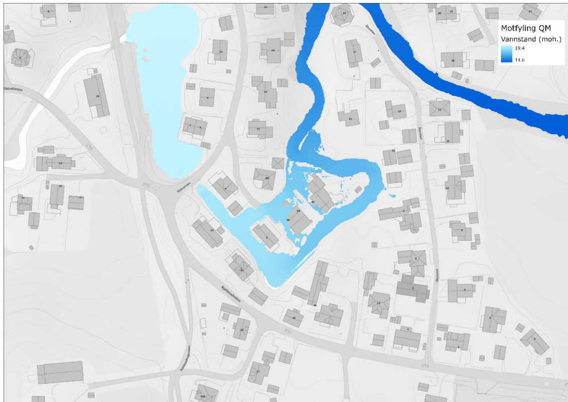
Figur 4-2 Flomutbredelse under planlagt situasjon med motfylling og middelflom. Flomutbredelsen øker sammenlignet med eksisterende situasjon.
