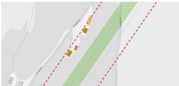
Figur 11-11 Øvregardane, alternativ 0, 1 og 4. Det ligger landbruksbygninger og boliger utenfor ryddebeltet, men nærmere enn 50 meter fra senterlinje.
