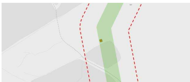
Figur 11-19 Ved Rugdeflotn, alternativ 2 og 3. En udefinert bygning ligger innenfor ryddebeltet.
