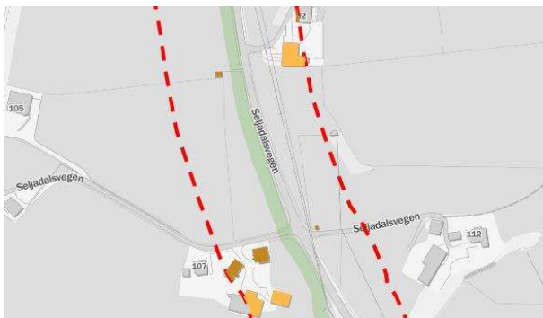
Figur 11-7 Seljadalsvegen, alternativ 0, 2 og 4: Ingen bygninger nærmere enn 5 meter fra jordkabel. En udefinert bygning, tre landbruksbygninger og to boliger nærmere enn 50 meter fra jordkabel.
