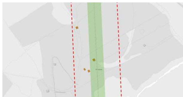
Figur 11-16 Arnastøl, alternativ 0, 1 og 3. En udefinert bygning innenfor ryddebeltet. Tre udefinerte bygninger til nærmere senterlinje enn 50 meter.
