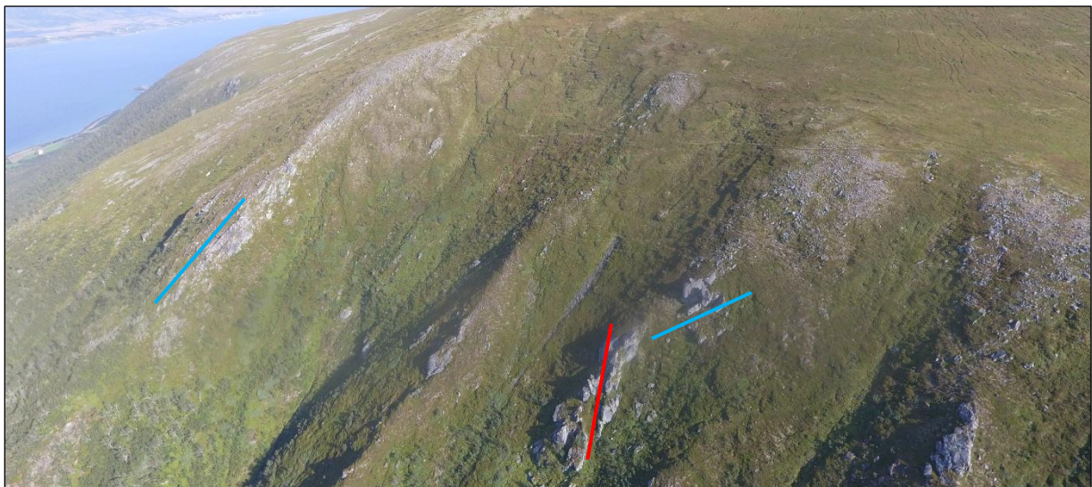
Figur 4: Dronebilde av enkelte av bergblotningene der bergmassestrukturer er synlige. Bergmassens sprekesett er indikert med linjer. Bildet er tatt mot NØ, parallelt med strøket til blått- og rødt sprekesett.
