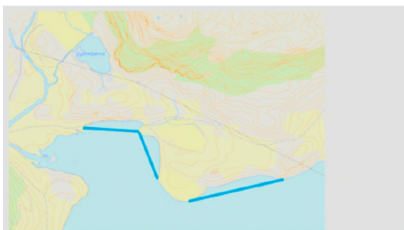
Figur 6: Plassering av siltgardiner i Birkelandsvatnet under anleggsarbeidene. Den vestre strekningen vil holde tilbake eventuelle oppvirvlede partikler fra utfyllingen i Birkelandsvatnet, og partikler fra deponi B3. Den midterste strekningen vil holde tilbake eventuelle sprengsteinpartikler og naturlige partikler fra graving og utfyllingen m.m. av deponi B3. Den østlige strekningen legges ikke ut med mindre det skjer endringer i opparbeidelsen av adkomstvegen og B3. Disse ligger ellers nord for høybrekket ut mot Birkelandsvatnet.
