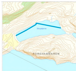
Figur 32: Plassering av siltgardiner under anleggsarbeidene
