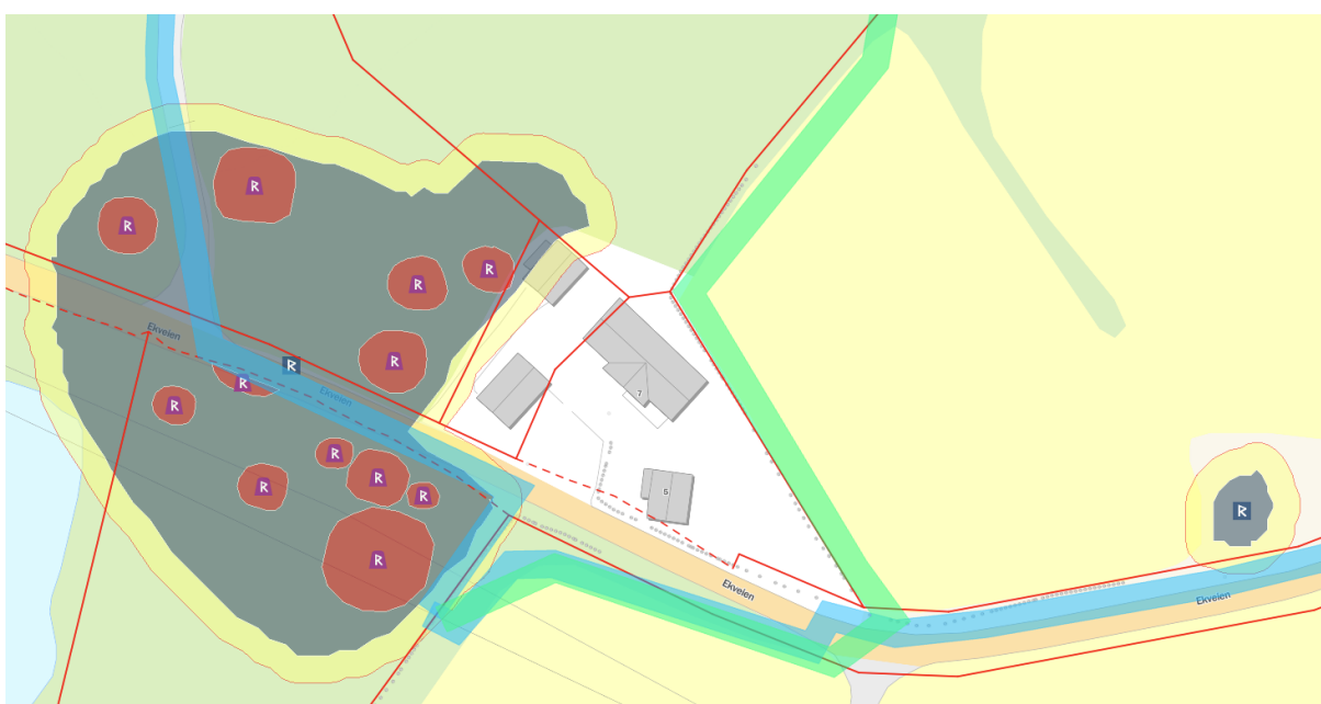
Figur 2-18 Vi har lagt til grunn et fem meter bredt tiltaksområde ifm graving av kabeltrasé, jf. blå og grønn linje på kartet. Automatisk freda gravfelt ID 49917 med enkeltminner i rødt og sikringssone i gult til venstre. Gravfelt ID 78478 til høyre.
