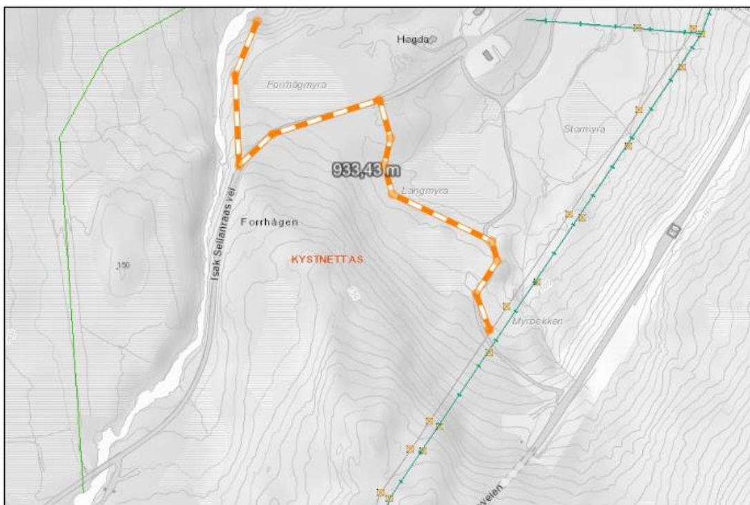
Figur 5: Planlagt kraftlinje for tilkobling på eksisterende nett vest for ny E6. Kilde: Konesjonssøknad, Hywer AS.
