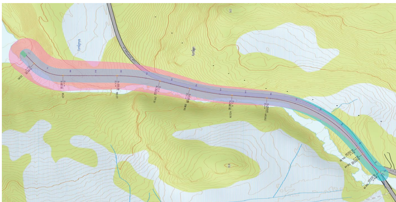
Figur 33 Teoretiske kastelengder ved rørbrudd (blå skravur = rørbrudd, rosa skravur = sprekk i rør)
