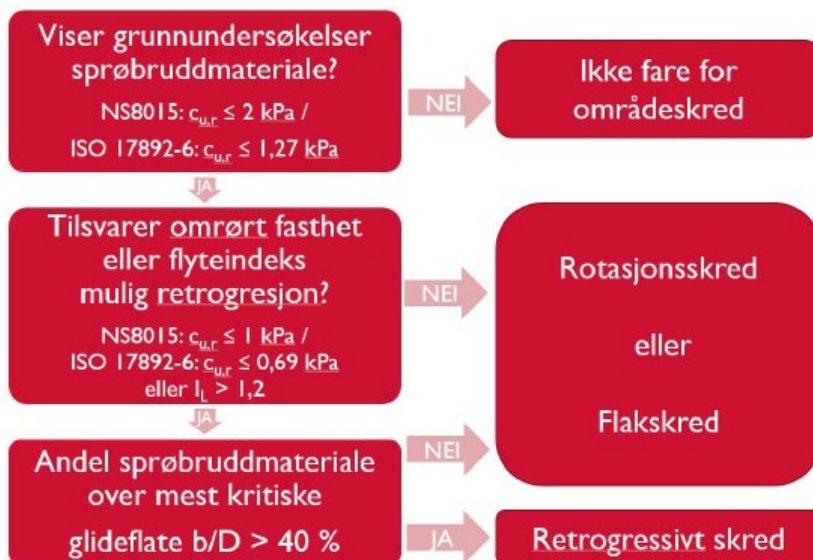
Figur 4.3 Flytskjema for vurdering av aktuell skredmekanisme
