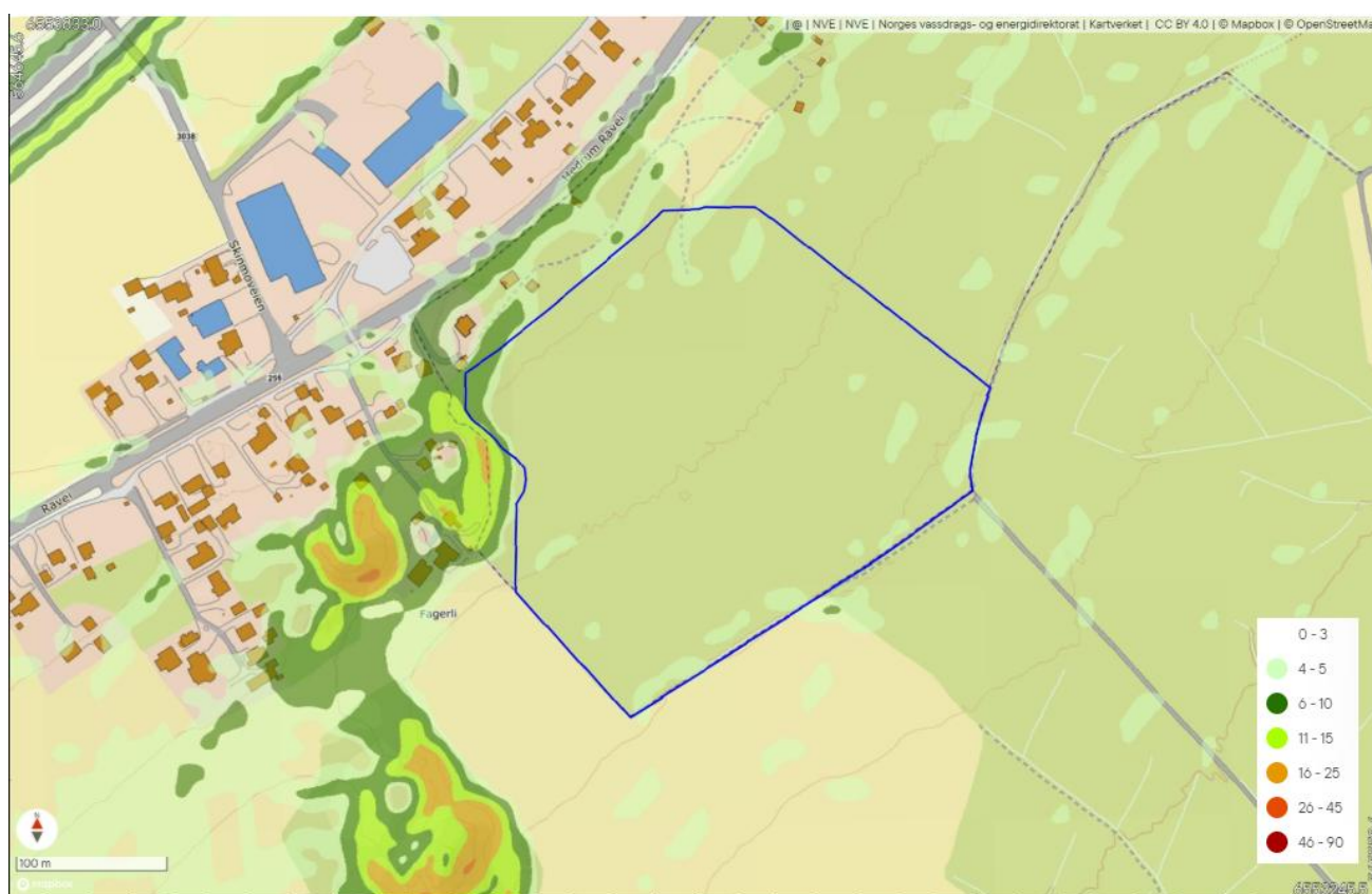
Figur 8 Oversikt over områder med helning over 4 grader. Planområdet er markert med blått omriss og
