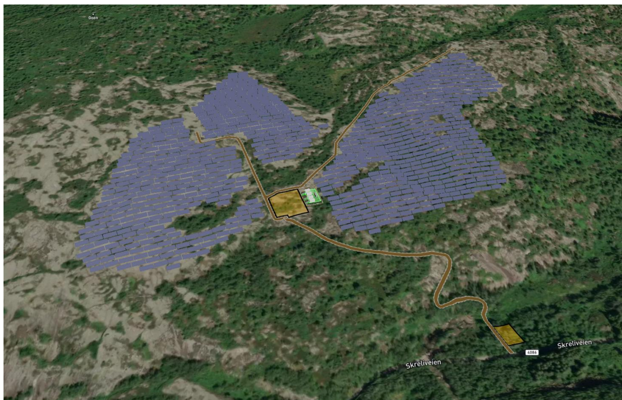
Figur 6: Planlagt utforming vist på kartgrunnlag, med solcellefelt, interne veier, transformator- og batteristasjon samt riggområder. Kilde: Solkraft Sør AS.
