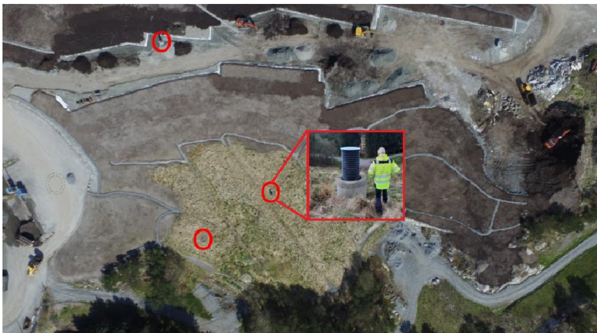
Figur 8: Ventilrør for vanninnsamlingsystemet og toppen av kumlokket.
