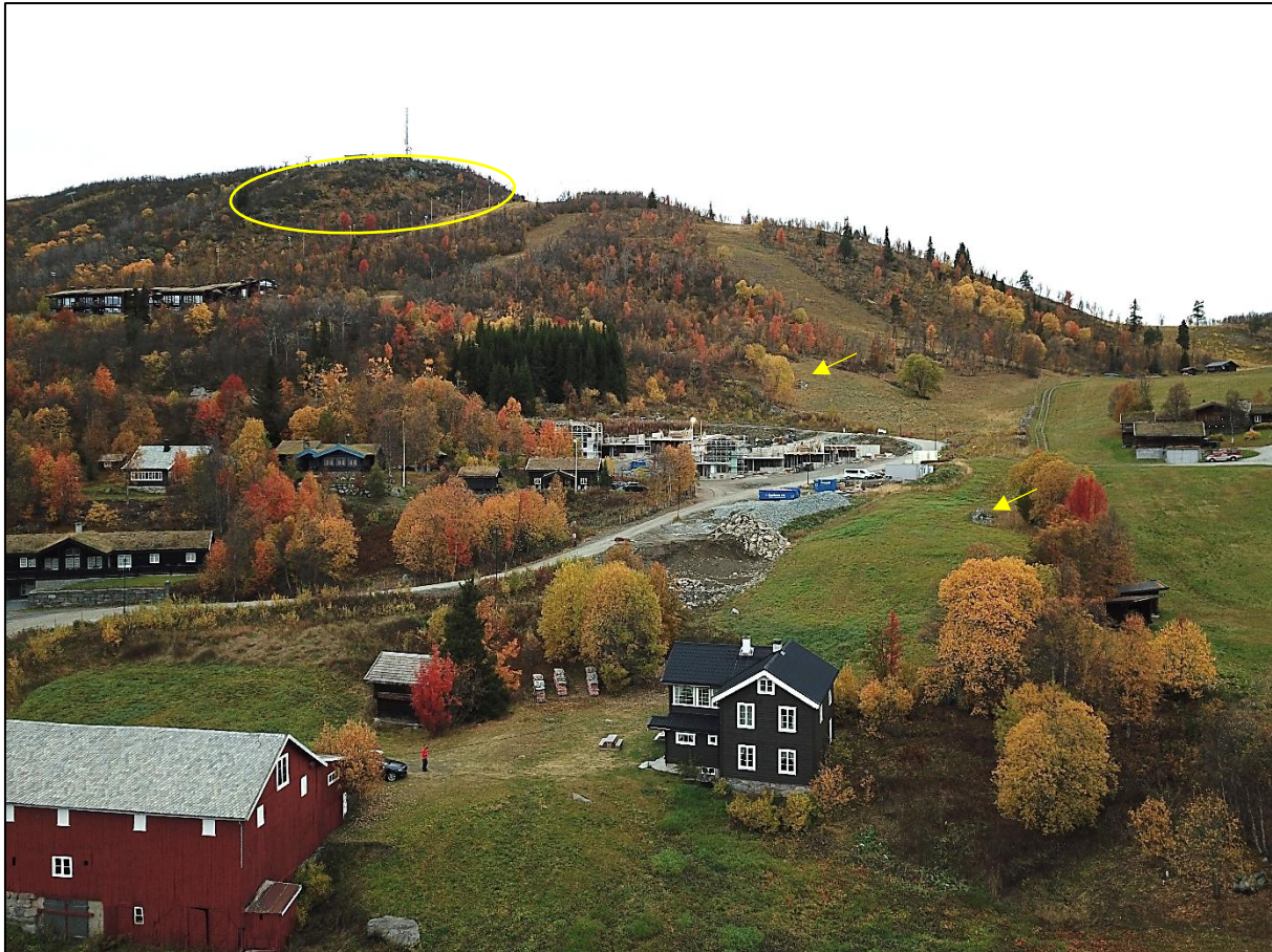
Figur 5: Dronebilde fra befaring i forbindelse med skredfarevurdering av nedre Slåtta. Bildet er tatt mot nordvest. Bergpartiene i sentrale deler av påvirkningsområdet er vist med gult omriss. Gule piler peker på områder med bergblotninger. Fotodato 2021-10-07.
