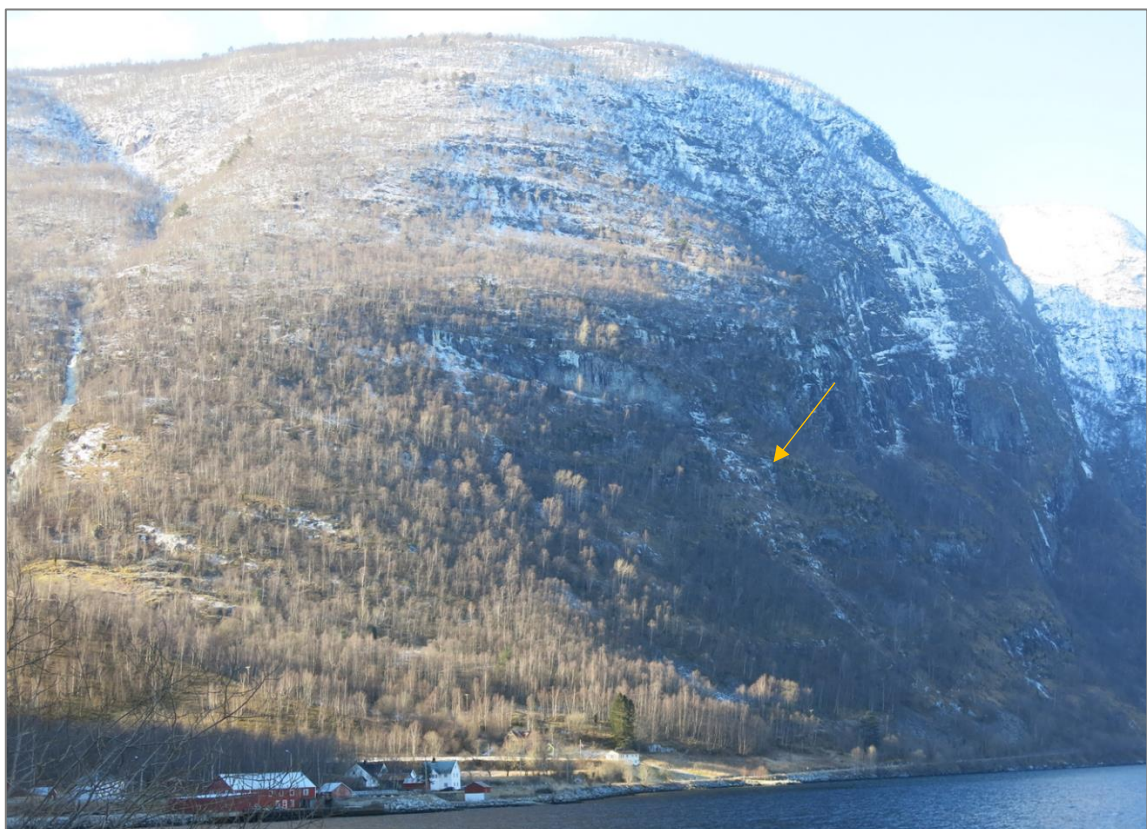
Bilde 1. Oversiktsbilde over undersøkelsesområdet og tilhørende skråning, sett mot vest. Pilen viser et større åpent område som trolig er en skredbane etter en større steinskredhendelse, se også Bilde 4.
