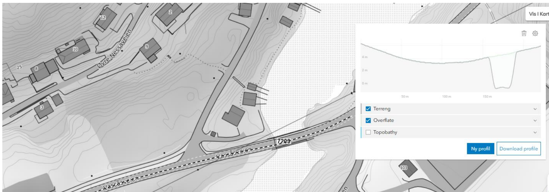
Figur 3: Utdrag fra hoydedata.no, laveste punkt på lavbrekk fylkesveg er ca. 1,3 m lavere enn topp bru.
