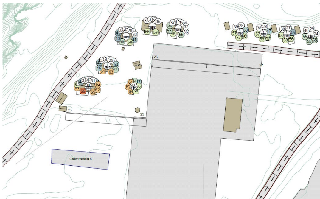
Figur 13 Beregnet lydnivå anleggsstøy ved graving nord for ny trafostasjon med jordvull som støydemper. Figur fra vedlegg 2, Multiconsult.
