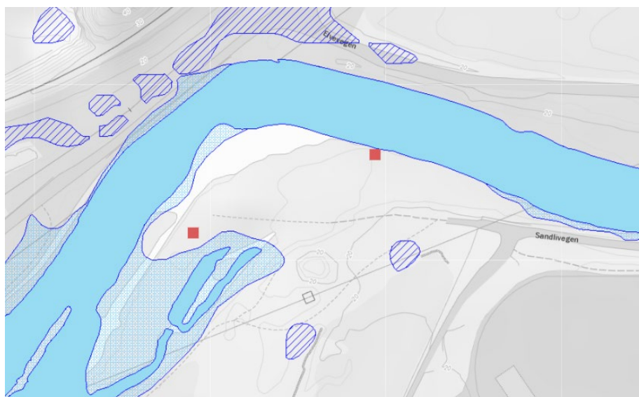
Figur 11 Plassering av gapahuker i ft flomfrekvens 1/200. Frekvens 1/10 er for øvrig nærmest tilsvarende. 1/20 er ikke beregnet, siden byggene også er innenfor 1/200.
