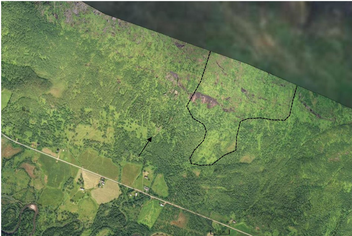
Figur 3: Flybilde tatt i 2004, som viser et område med tynnere vegetasjon enn ellers, sannsynligvis pga. snøskred. Pilen viser steinsprangblokken med lengst utløp i fjellsiden.
