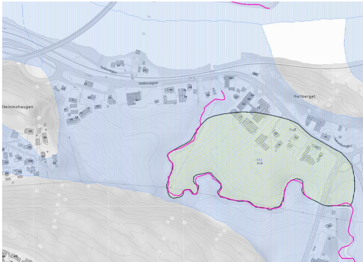
Figur 14 Utklipp fra NVE-Atlas med "Mulighet for sammenhengende forekomster av marin leire" og eksisterende kvikkleiresone markert. Rosa sterk viser området med utført tiltak i bekken
