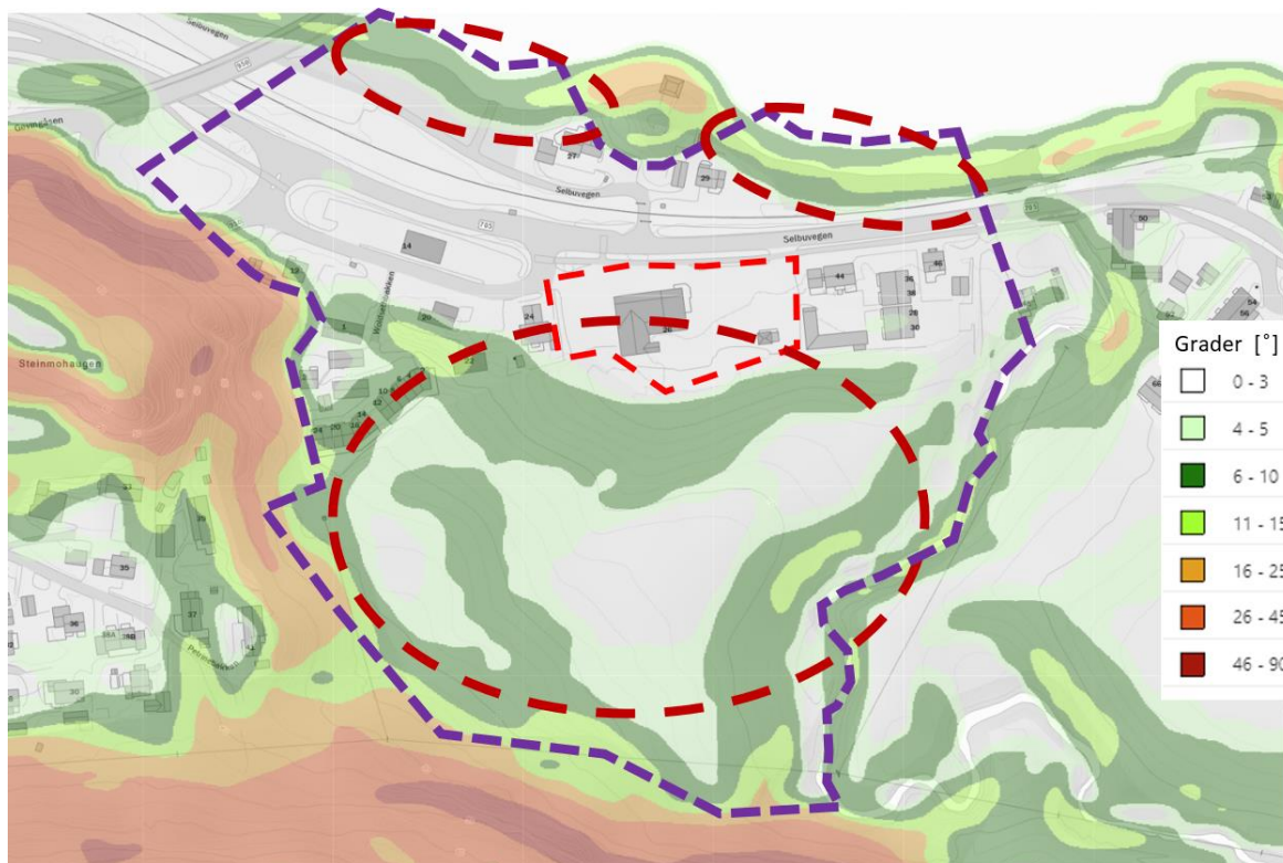
Figur 16 - Identifiserte kritiske skråninger. Kvikkleireforekomst er tegnet med lilla, de mørkerøde sirklene angir kritiske skråninger
