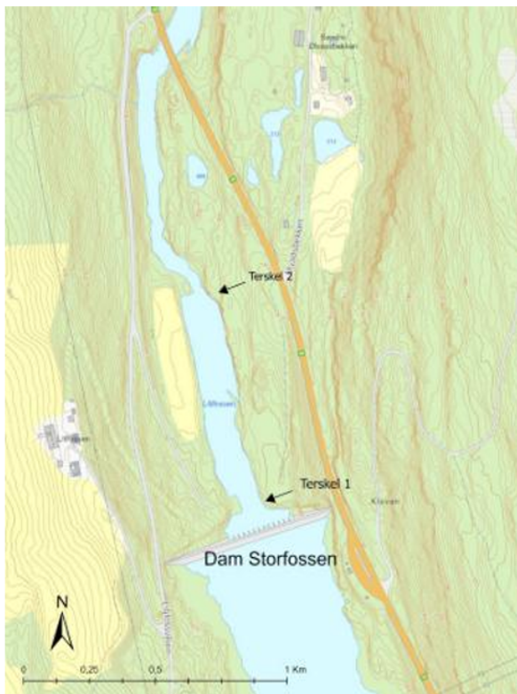
Figur 1. Oversiktskart over Storfosdammen og de to terskelbassengene som skal tørrlegges. Terskel 1 på kartet er «Terskel nedstrøms Storfosdammen» og Terskel 2 er «terskel 37D». Midlertidig minstevannføringsarrangement vil ha utløp like nedstrøms terskel 2. Figur er hentet fra søknaden.
