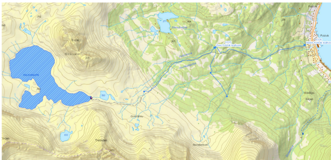
Figur 1: Oversiktskart over tiltaksområdet til Øvre og Nedre Foldvik kraftverk. Samtlige omsøkte kabelanlegg legges i samme grøft som rørgatetraseer utenom en ca. 30 meter lang jordkabel fra Nedre Foldvik kraftverk frem til tilknytningspunkt i overliggende nett tilhørende Noranett (se figur 2).
