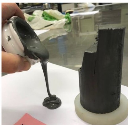
Figur 2 Oppførsel sprøbruddmateriale, omrørt til venstre og intakt til høyre
