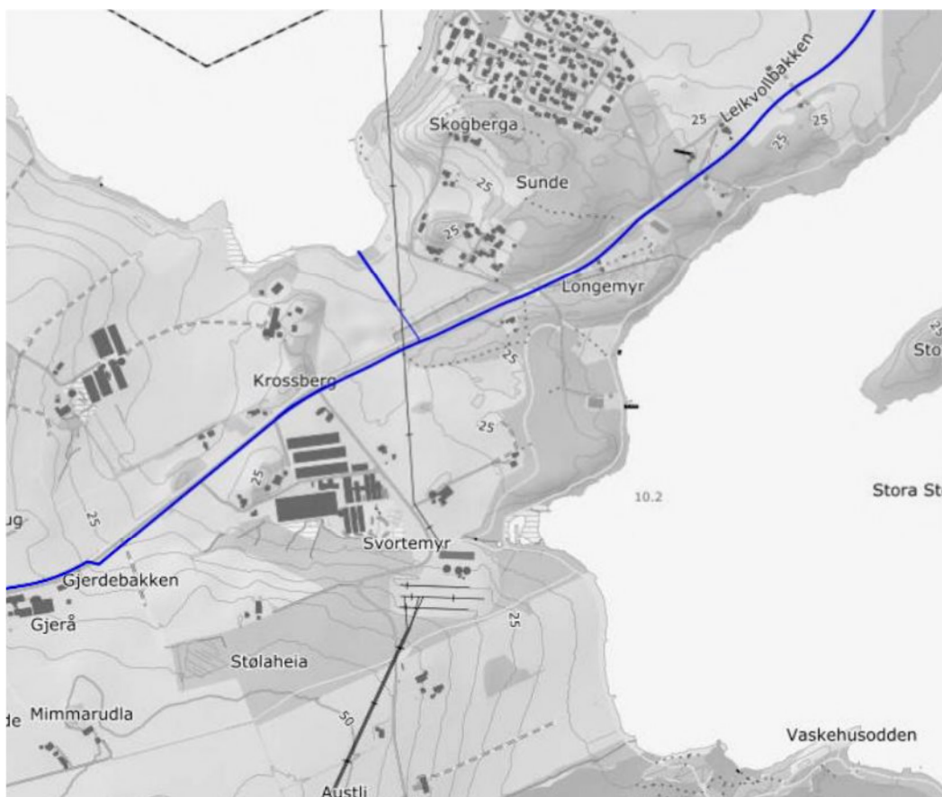
Vannledning Ø600 mm ved Krossberg.
