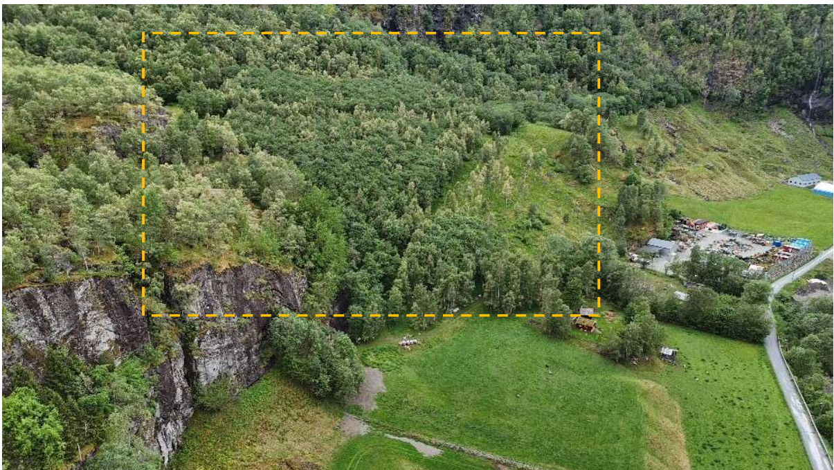
Figur 4-7 Revegetert eldre tipp fra 80-tallet i bakkant av Tuppeberget. Området er markert med oransje stiplet strek. Lagerplass langs vei mot Låvi sees til høyre i bildet.
