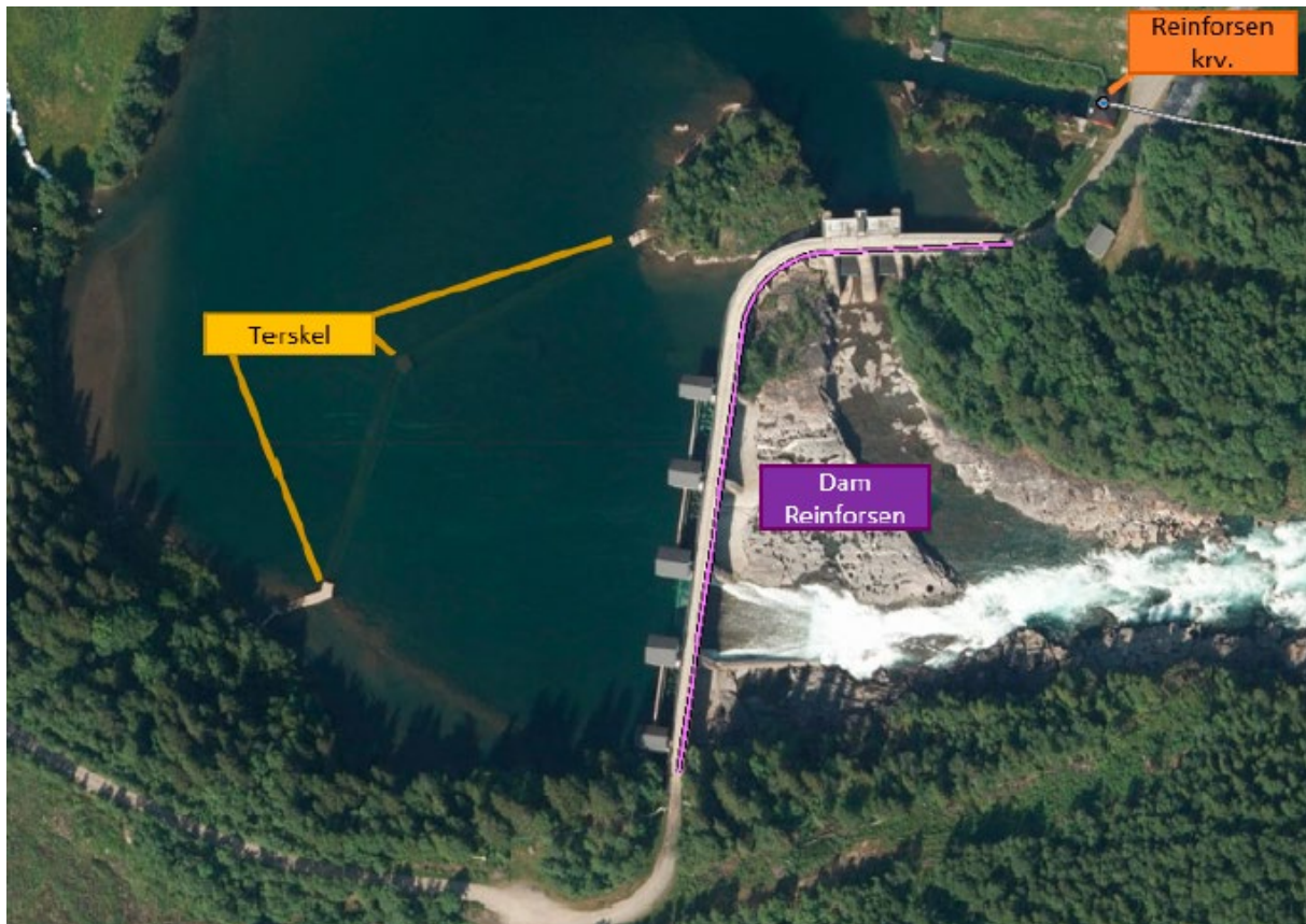
Figur 15: Rett oppstrøms dam Reinforsen ligger det en terskel som hadde større funksjon før dam Reinforsen ble bygget. Dens høyde tilsvarer laveste regulerte vannstand (LRV) i Langvatnet. Kilde: NVE-Atlas.
