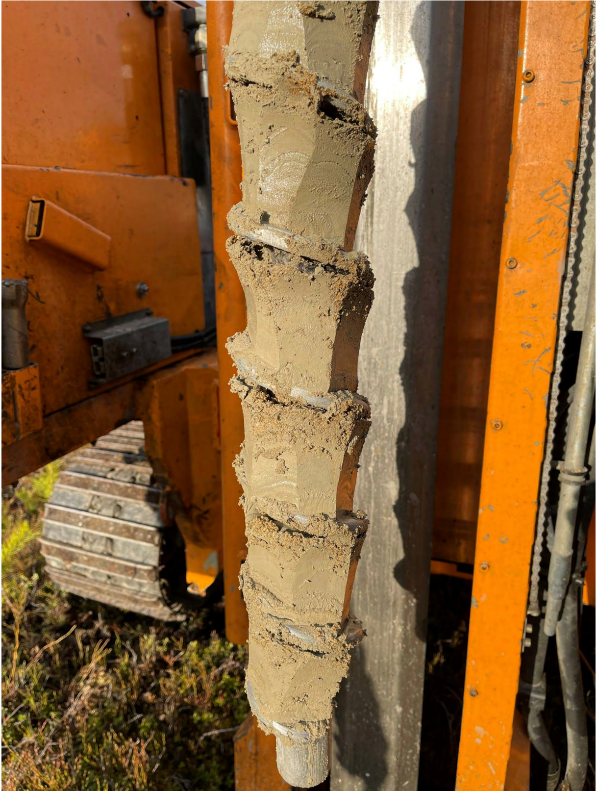
Figur 6: Nærbilde av masser fra bunn 3-4 meter i borpunkt 5.
