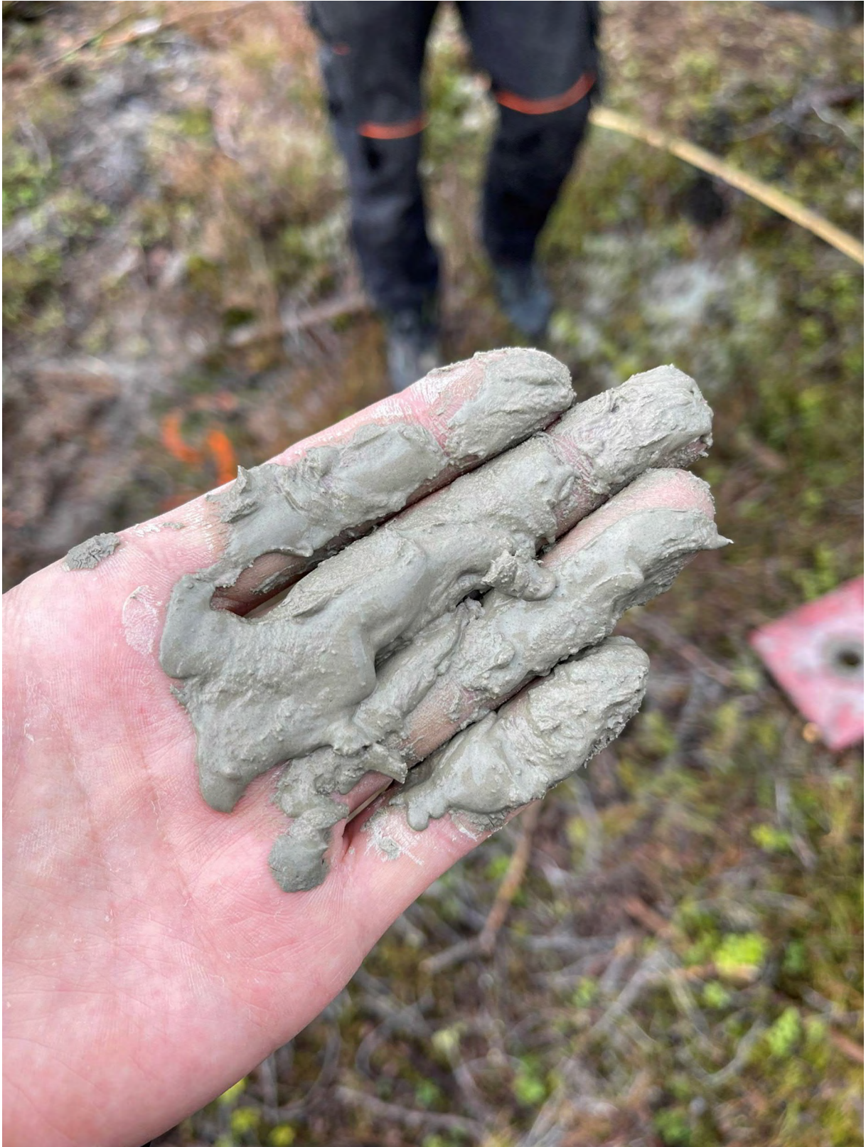
Figur 8: Bløte masser fra 4-5 meter i borpunkt 5.
