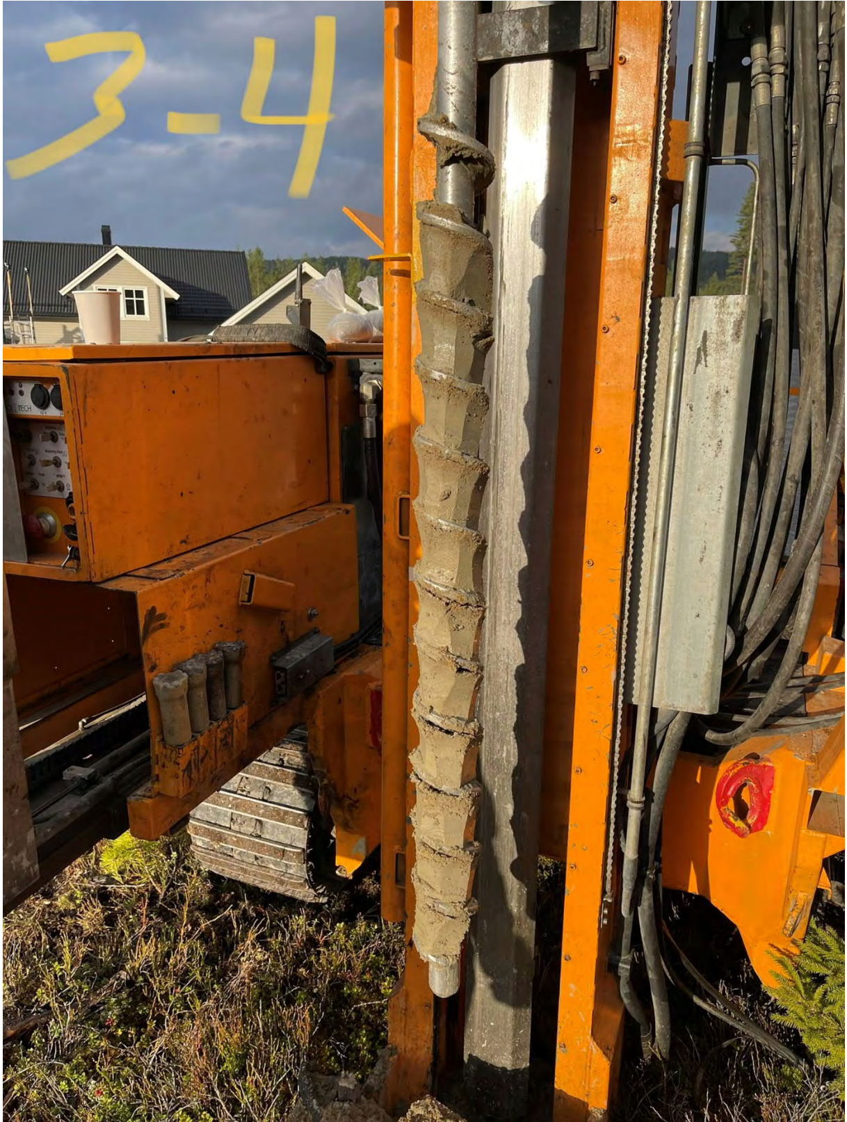
Figur 4: 3-4 meter, leirig silt, litt bløt.
