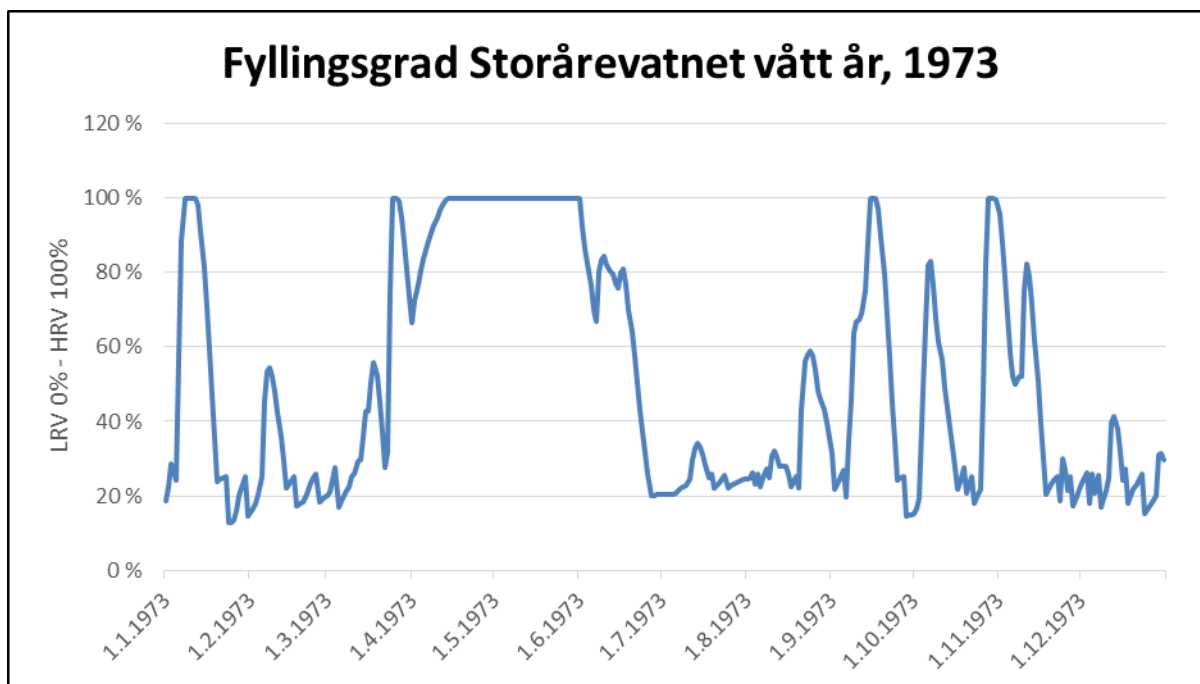
Figur 19: Plott som viser fyllingskurve, altså hvordan magasin Storårevatnet kjøres gjennom året i et vått år
