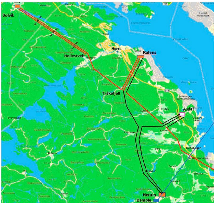
Figur 24: Skisse over alternativ 2 i den oppdaterte konseptvalgutredning. Sorte linjer indikerer nye 132 kV ledningsstrek. Røde linjer viser videreførte eksisterende ledningsstrek. Rektangler indikerer transformatorstasjoner.
