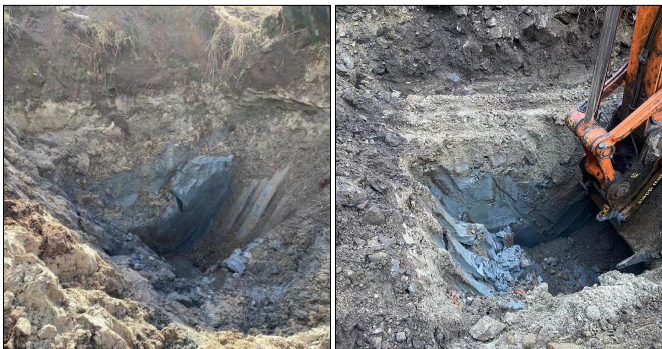
Figur 11: Synlig «blåleire» i hull 5 (venstre) og 4 (høyre).
