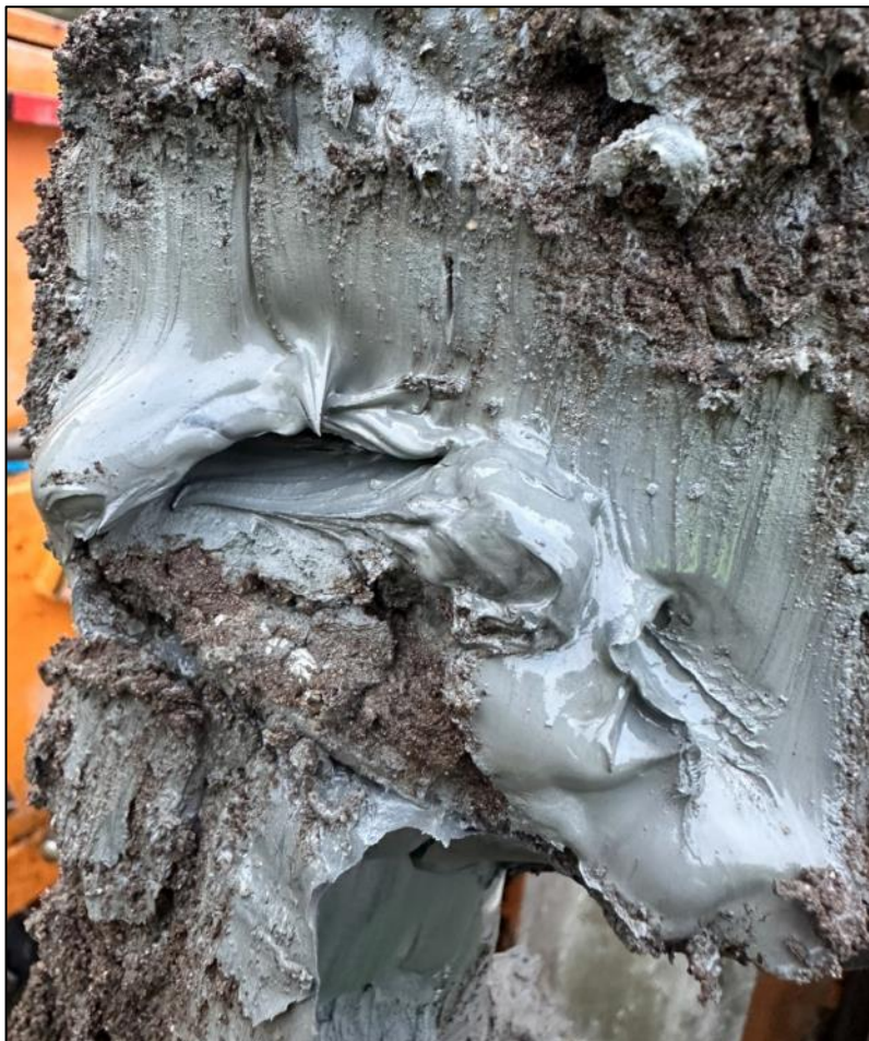
Figur 16: Sprøbruddmateriale i borpunkt BP3 fra naver i felt.
