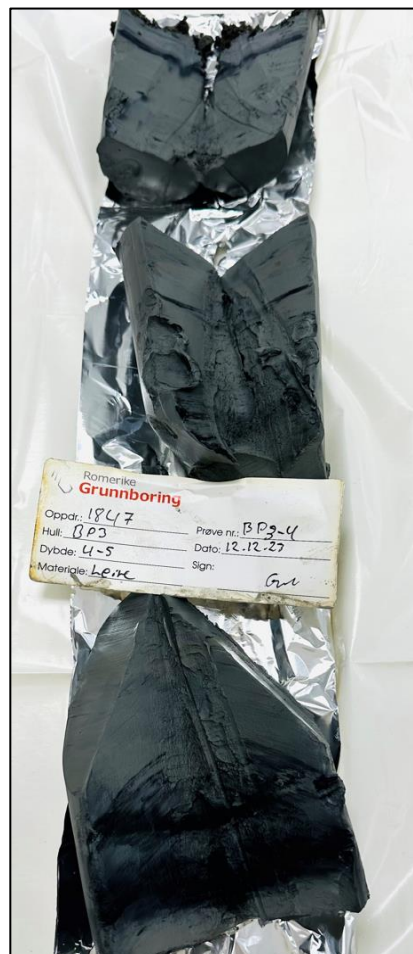
Figur 17: Cylinderprøve fra BP3.
