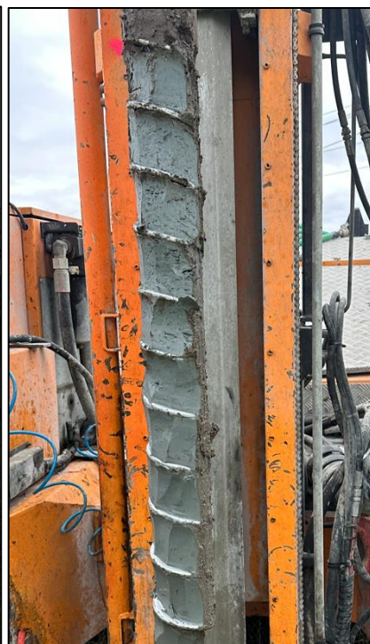
Figur 14: Naver med leire fra 1-2 m dybde.
