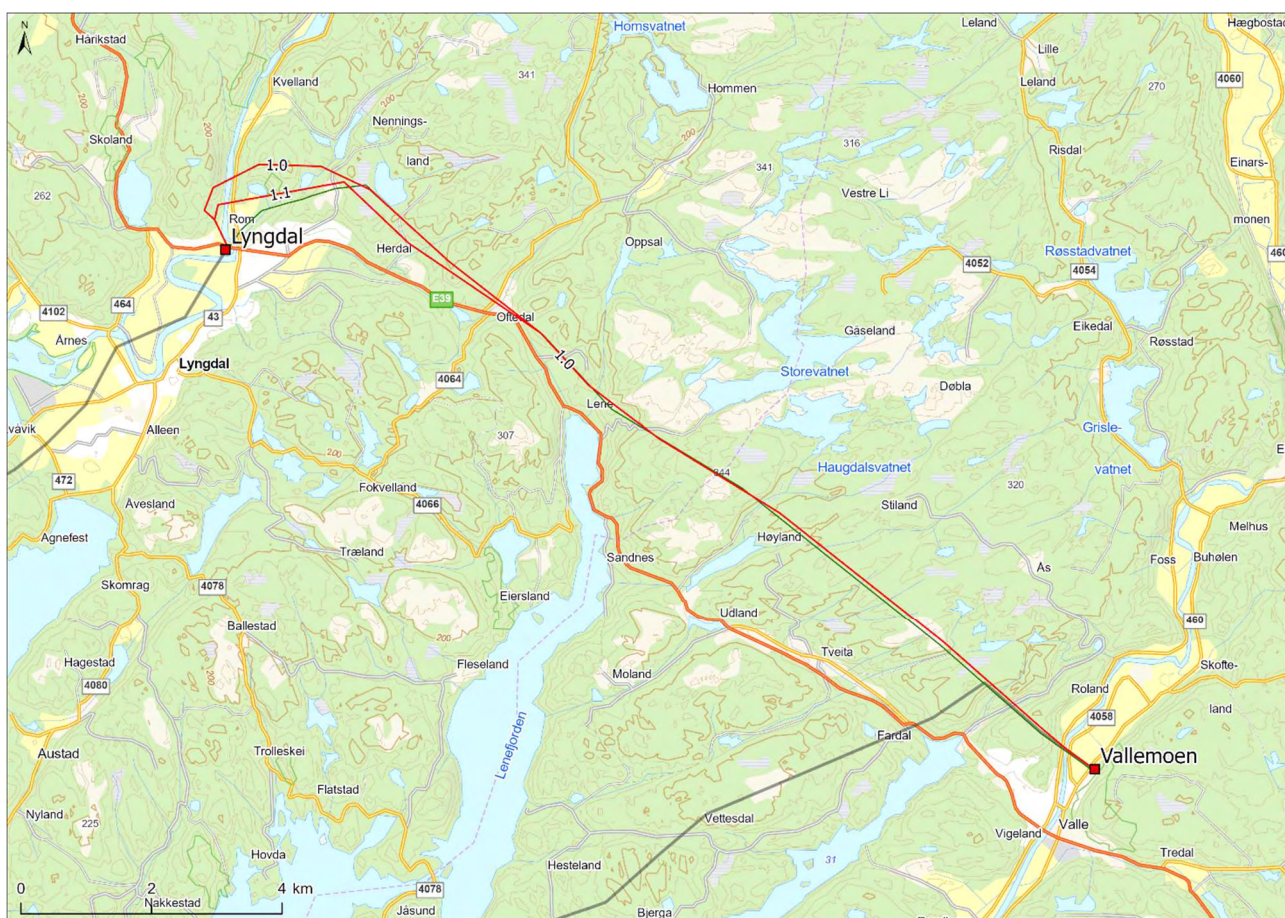
Figur 1-4. Ledningsalternativer mellom Vallemoen og Lyngdal som er konsekvensutredet. Rød strek er nye traséalternativer og grønn strek er eksisterende 110 kV ledning som rives.
