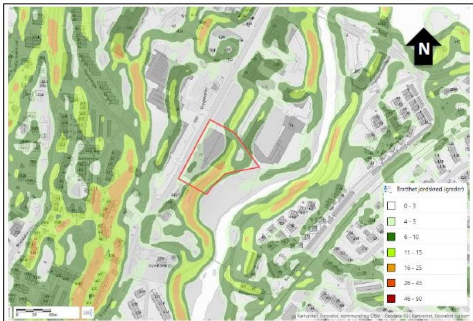
Bilde 2.4 NVEs bratthetskart som viser helningsforhold i området. (Tomten er markert med rød linje. Kilde: Rapport [1])
