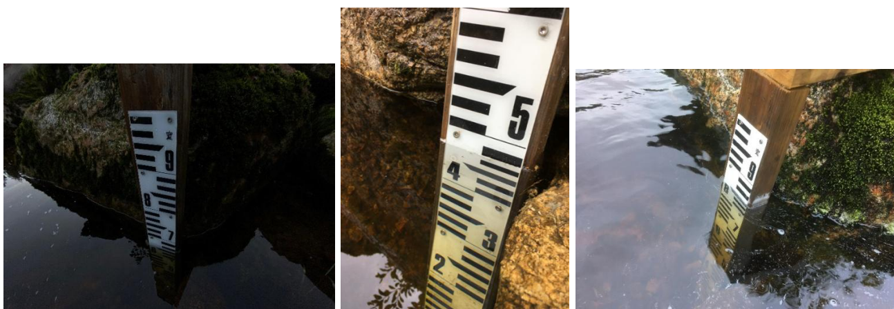
Figur 16. Bilder av målekummen ved Feed skianlegg med målestaven som viser vannstand. T.v.: 18. oktober (målestav 67 cm). I midten: 19. august (målestav 47 cm). T.h.: 20. oktober (målestav 85 cm).
