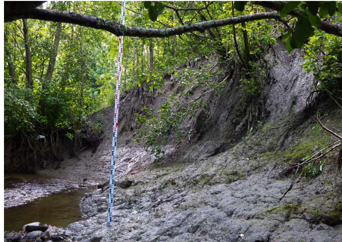
Bilde 4: P26. Utglidning med mye blottlagt leire
