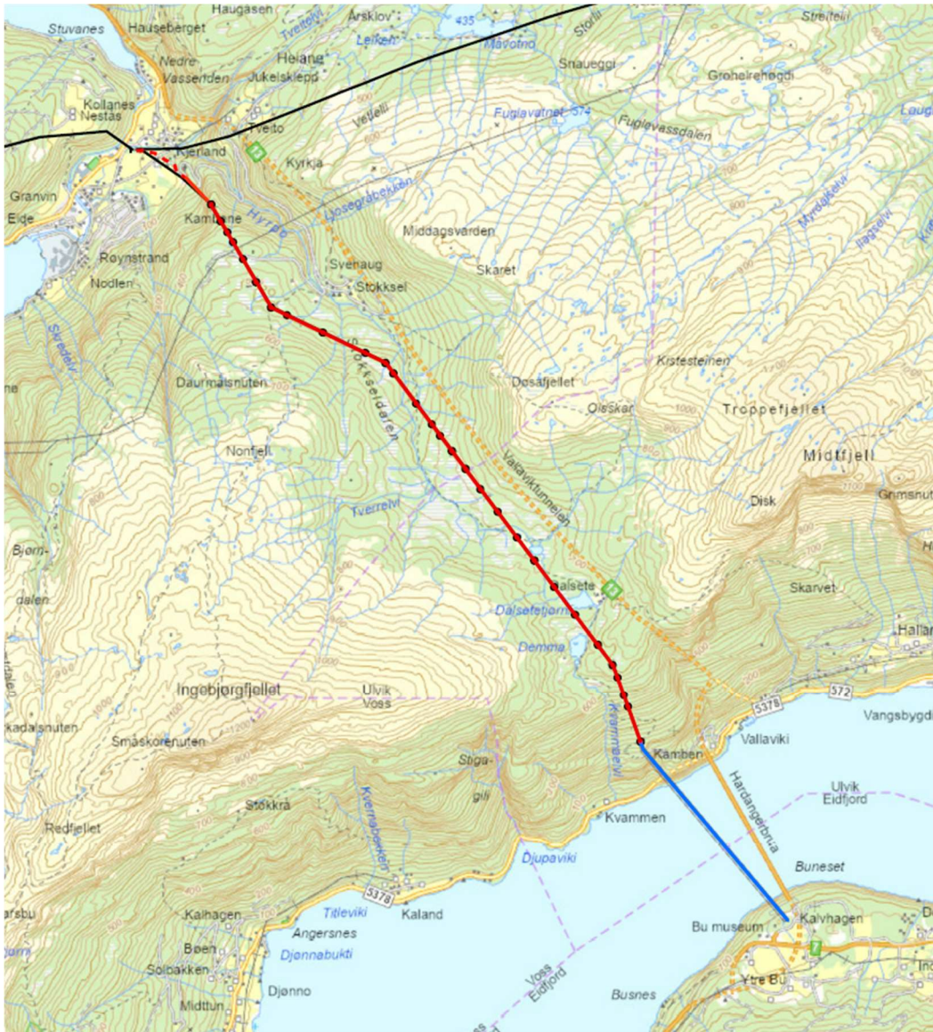
Figur 1. Oversiktskart som viser anlegget som skal bygges. Rød strek representerer ny kraftledning som skal bygges, blå strek viser eksisterende fjordspenn som beholdes over Hardangerfjorden.
