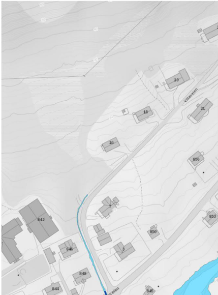
Figur 4-20. Sidebekk 2 går i vegggrøft langs Villavegen.
