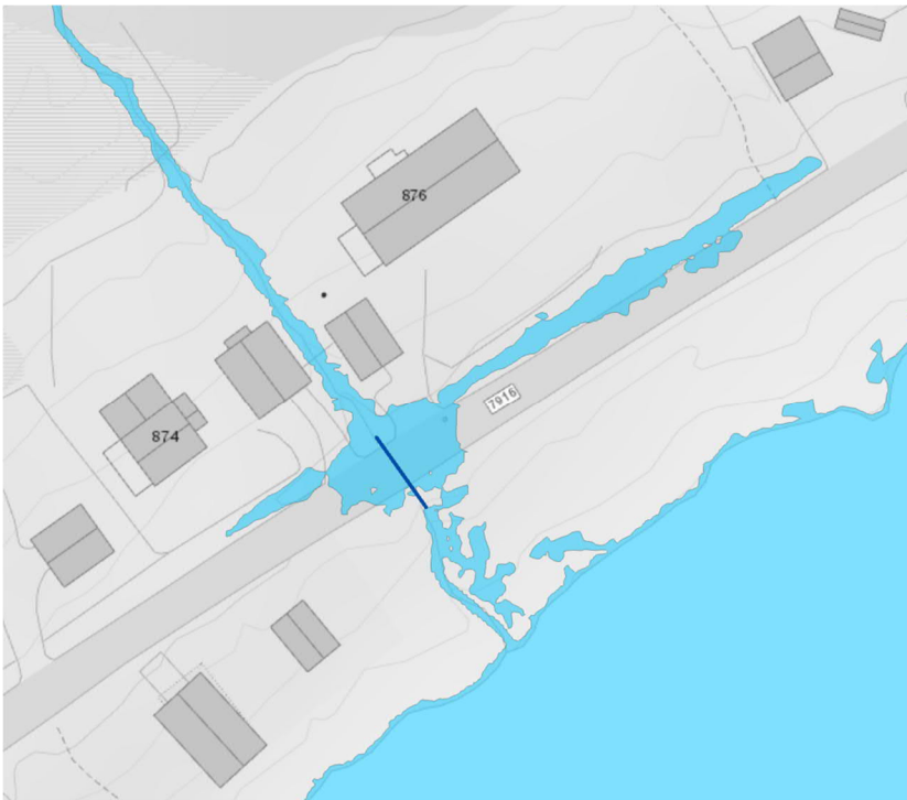
Figur 4-18. Stikkrenna under fylkesvegen for sidebekk 3 har ikke kapasitet for 200-årsflom med klimapåslag.
