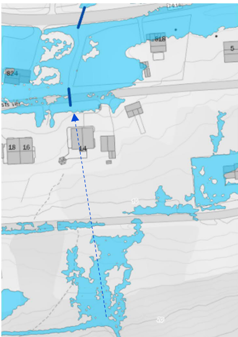
Figur 4-19. Mulig overvannssystem (stiplet pil) som leder sidebekk 1 mot stikkrenner (mørkeblå strek) under H.M. Holsts vei, fylkesveg og Gammelvegen.
