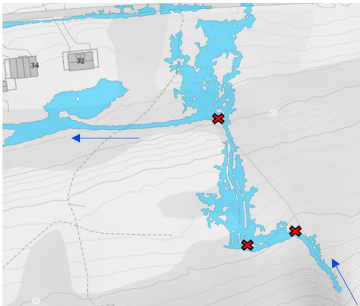
Figur 4-12. Bekkeløpet for sidebekk 1 har ikke kapasitet. Løpet gjør tre brå svinger (kryss). Blå piler viser vannets dominerende retning.
