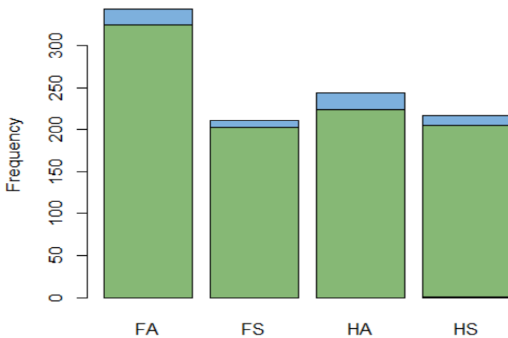
Figur 24. Flest fisk (laks = grønn, sjøørret = blå) vandret opp fisketrappa i Skotfoss i 2021 når inntaksluke var Fullt åpen (F) og begge omløpsrør var Åpne (A) dvs. med fullt lokkevann (= FA; FS = Fullt åpen inntaksluke, Stengte rør; HA = Halvåpen inntaksluke, Åpne rør; HS = Halv luke, Stengte rør). Figuren viser data for all fisk oppvandret i forsøksperioden 30.06-30.09.2021.
