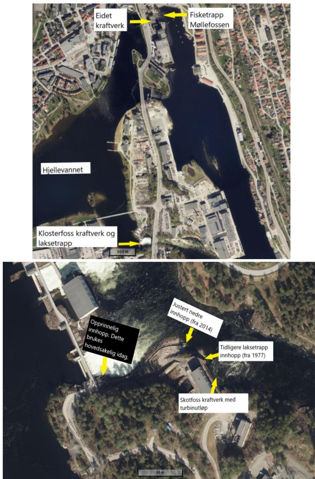
Figur 7. Øverst: Skiensfallene med Klosterfoss og Eidet kraftverk og fisketrapper i Klosterfoss og Møllefoss hvor fisk kan vandre opp fra brakkvann i Bryggevatnet og opp i Hjellevannet. Nederst: Skotfoss kraftverk og fisketrapp. De to nedre innløpene ved undervann Skotfoss kraftverk er ikke i bruk i dag.
