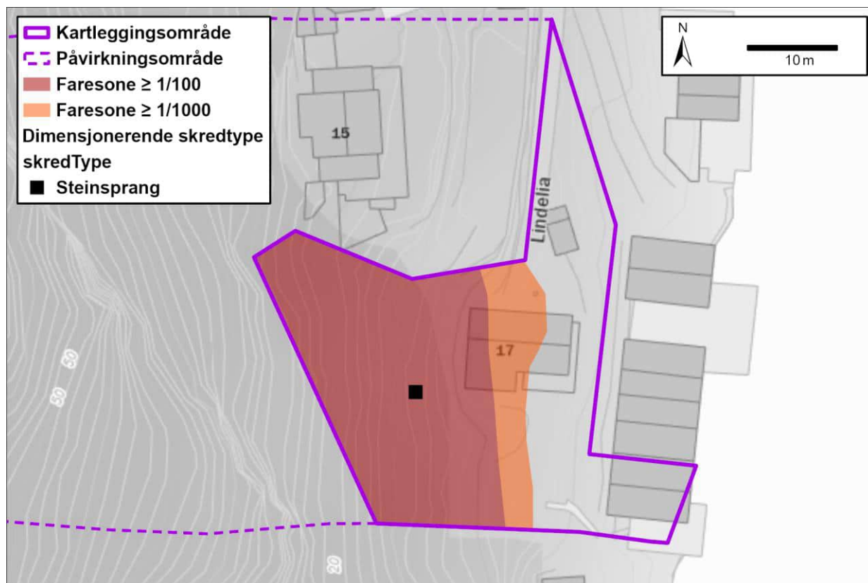
Figur 9: Oversikt over faresone \geq 1/100 og \geq 1/1000 som gjelder for sikkerhetsklasse S1 og S2.
