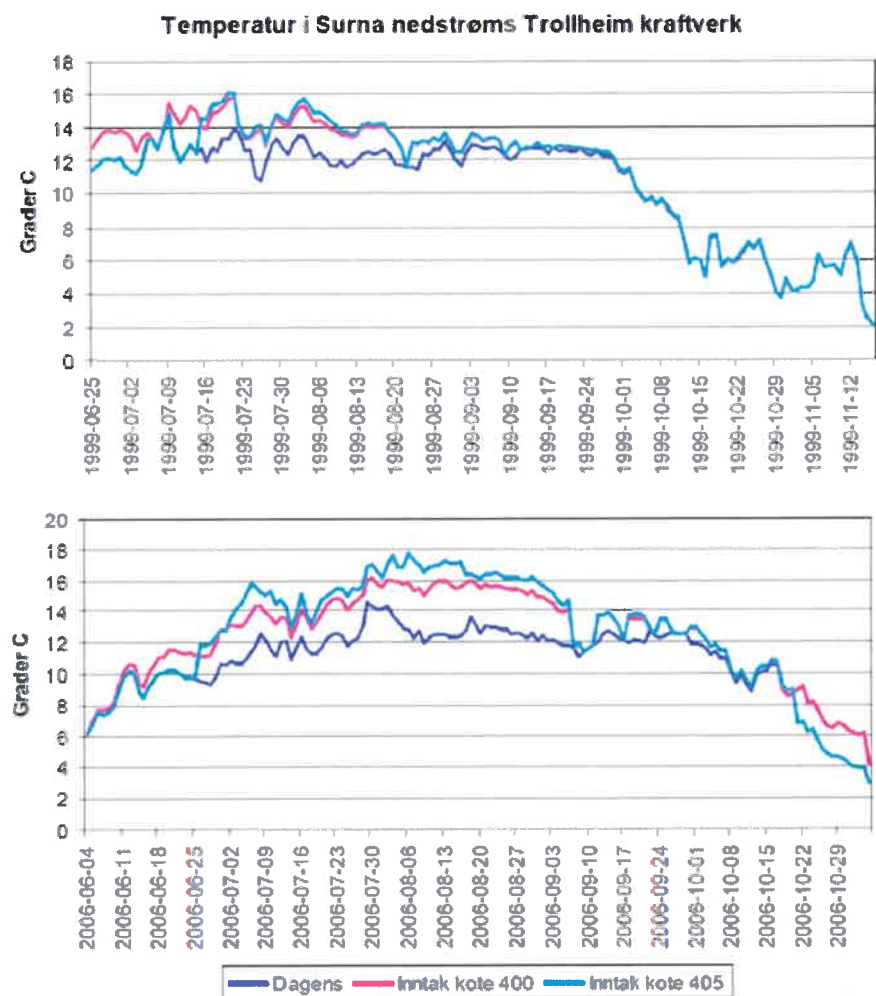
Figur 14. Beregnet vanntemperatur i Surna nedenfor Trollheim kraftverk med inntak som i dag, på kote 400 og kote 405. (Harby m.fl 2013)
