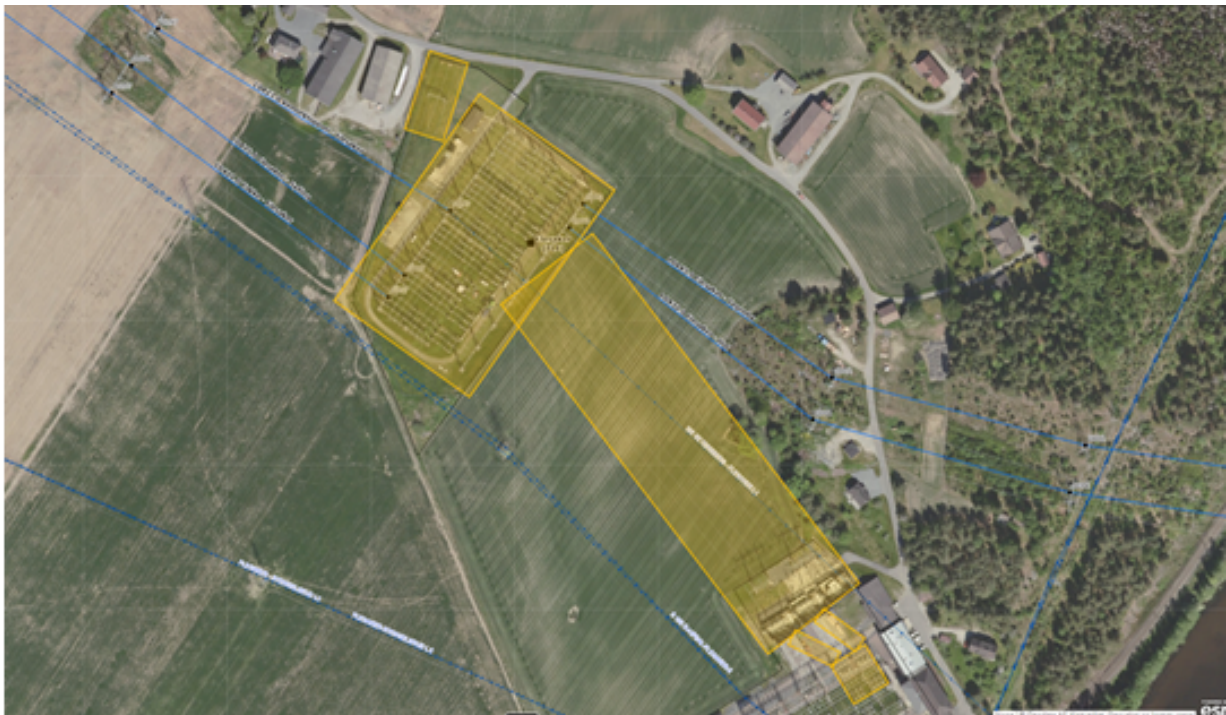
Figur 11: Anlegg Statnett har søkt om å rive ved Flesaker transformatorstasjon. De to øverste gule firkantene viser Statnetts øvingsanlegg. Den midterste gule firkanten er ledninger som skal rives og de nederste tre gule firkantene er Statnetts anlegg ved Flesaker transformatorstasjon. Kilde: Statnett
