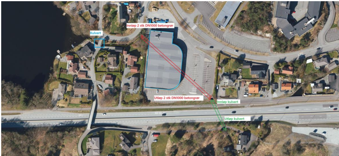
Figur 3: Kulverter ved utløpet av Birkelandsvatnet.
