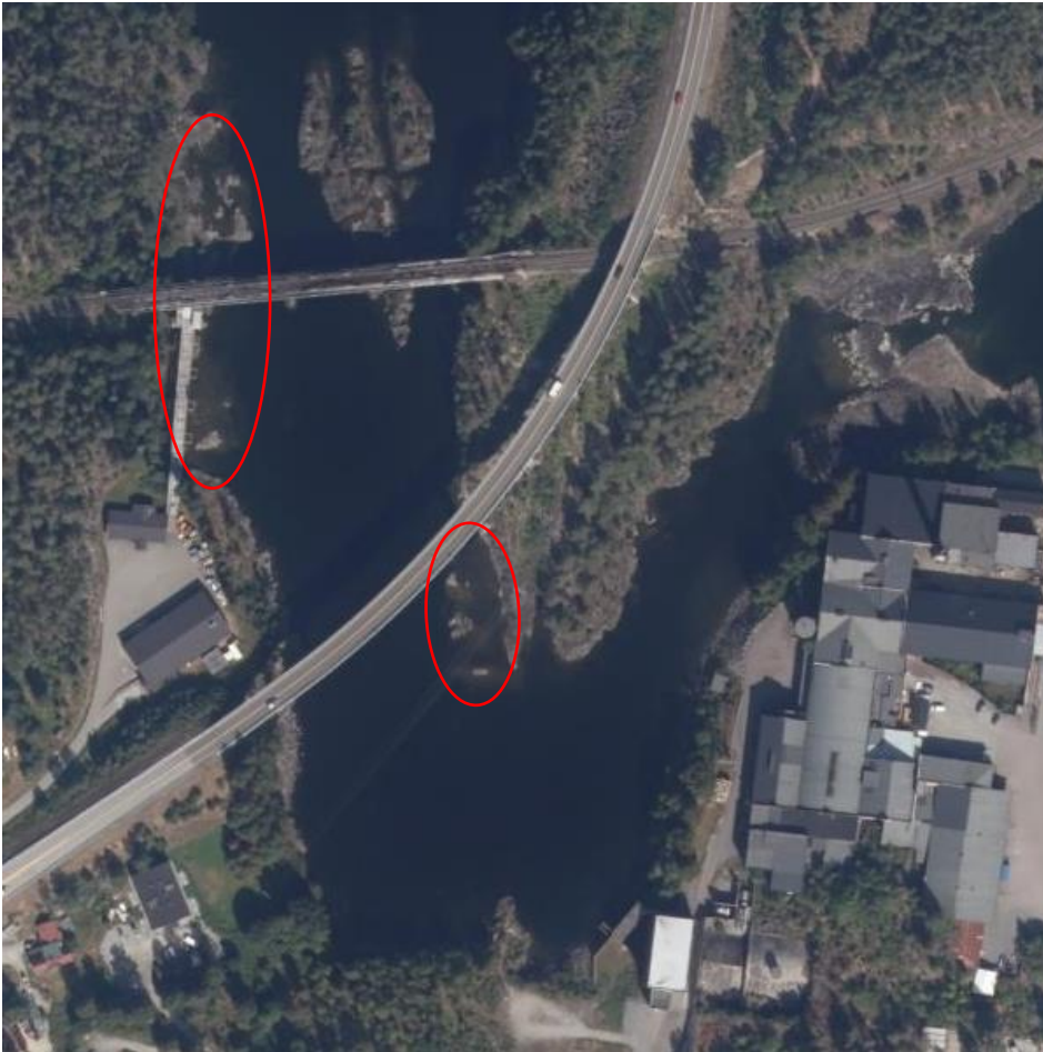
Figur 19: Øst for Katfoss industriområde danner Katfossen en terskel i elva og stuer opp vann oppstrøms. To områder ble undersøkt i forbindelse med vannstandsreduksjonen, men det ble ikke observert endringer i vannstanden ved disse to områdene. Terskelen ved Katfossen holder på vannstanden oppstrøms.
