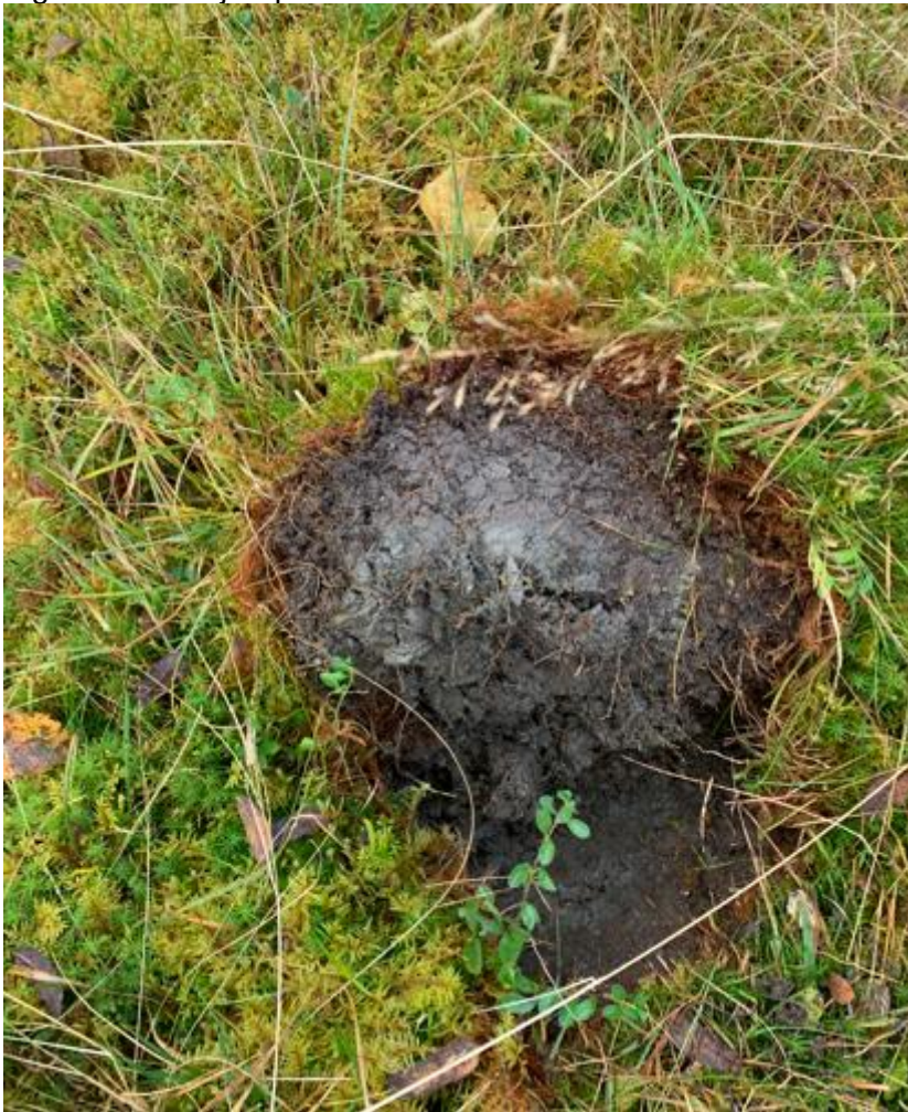
Figur 4-1 Jordprofil fra arealet på Dalastølane. dybden til fjell var her 20 cm. Ca 5 cm med torv etterfulgt av grusholdig, siltig sand. Jordsmonnet er grunnvannspåvirket.
