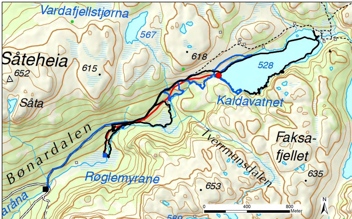
Figur 3.4. Befaringsrute (blå linje: 8. november 2018, svart linje: 27. juni 2019). De planlagte tiltakene er vist med rødt punkt for inntak/dam, blå firkant for kraftstasjon og rød linje for rørgate. Svart firkant viser inntak for kraftverket Bøen II.
