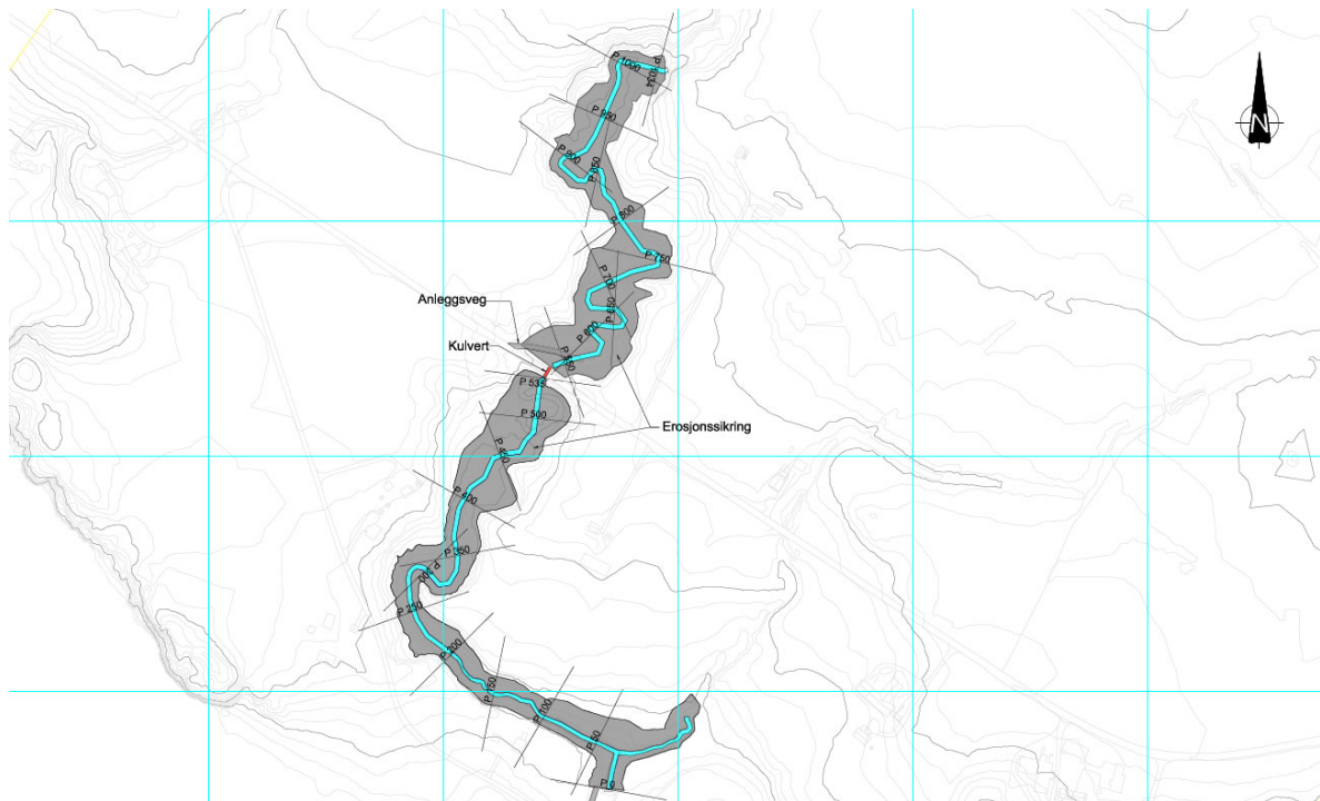
Figur 3: Utsnitt av plantegning (-TEG-900) med markering av område for erosjonssikring langs Steinselva
